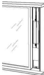
4. Stopfen Sie die Schaumstoffdichtung A zwischen das Glas und das Fenster, um zu verhindern, dass Luft und Insekten in das Zimmer gelangen.
